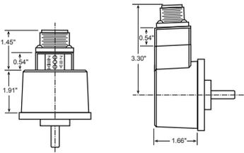
0: 轴向 M12 连接器 1: 径向 M12 连接器
